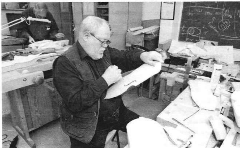
Sverker Ek kunde inte komma förra gången. På bilden ser vi hur han skär ut f-hål i ett av sina två harplock. Med diverse assistans från andra byggare lyckades han få på locken på bägge harporna och kommer nu att kunna koncentrera sig på lekarna.
