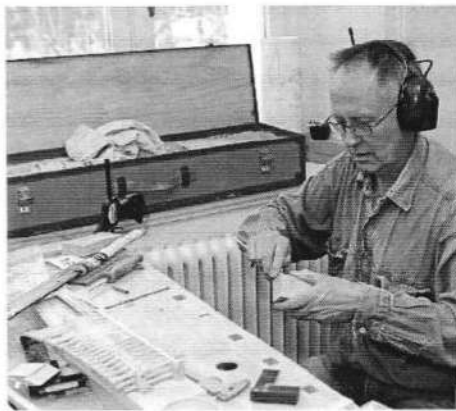
Bosse Nilsson från Sickla gör lövtappar till sina två nyckelharpor.
